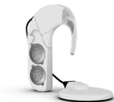
Le processeur OPUS2 en version « XS » (*Extra Small*) offre une nouvelle solution alternative d'alimentation à 2 piles (au lieu de 3 jusqu'à présent) pour une réduction de taille (-15% avec 49 mm de longueur) et de poids (-25% avec 9,4 g).
