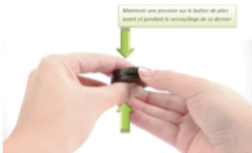
Appuyer sur le Rondo tout en faisant glisser l'interrupteur marche / arrêt vers la gauche (3), position '0' Verrouillage. Pour allumer le processeur faire glisser encore une fois vers la gauche (4), position 'I' Allumé.
